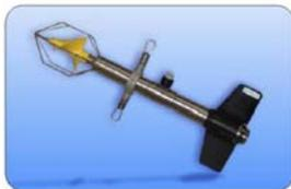
Se clasifican como tal, los que miden directa o casi directamente la o las variables físicas de interés. Es el caso de un flujómetro de hélice, donde la velocidad de rotación de la misma, es función directa de la transferencia de energía del escurrimiento del agua por desviación y deslizamiento, e inversa de la fricción. Los rotámetros, o flujómetros de vano de velocidad constante, también son un buen ejemplo de la clasificación de Primer Orden, como lo es también el termómetro de mercurio.
